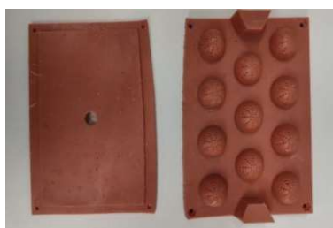
Figura 4. Tampa e contramolde após primeira impressão.
