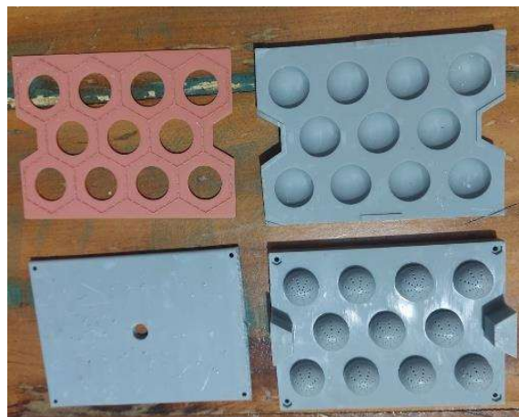
Figura 5. Impressão em resina das peças do molde e contramolde do projeto.
